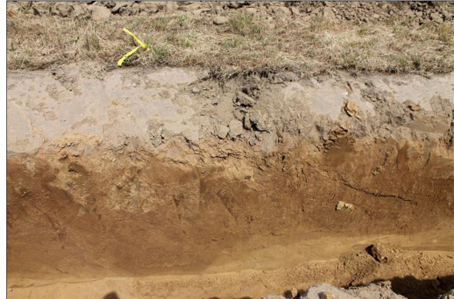
Beispiel für die Anlage eines Schurfes senkrecht zu einer Störungslinie in Aldenhoven.
