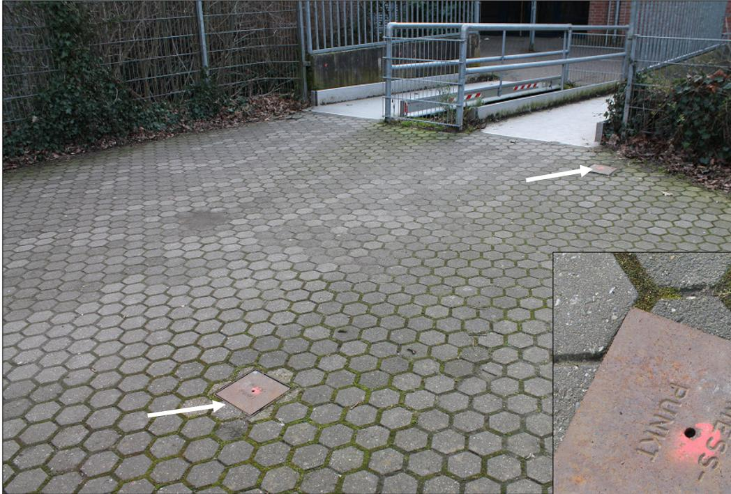
Beispiel für eine Messlinie mit Bodenpunkten senkrecht zu einer Störungslinie.
